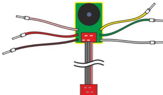
Jeder Tasteneingang unterscheidet die Betätigung **“KURZ, LANG und LOS”**. Der erste LCN-T4I wirkt auf die A-Tabelle, Taste 1-4, der zweite auf die A-Tabelle Taste 5-8
